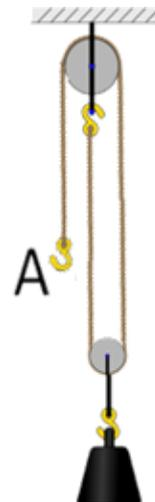
**B.1.** Να υπολογίσετε την ελάχιστη δύναμη  $F_{min}$  που πρέπει να ασκηθεί στο άκρο Α του σχοινιού, ώστε να ανυψωθεί το κιβώτιο.
